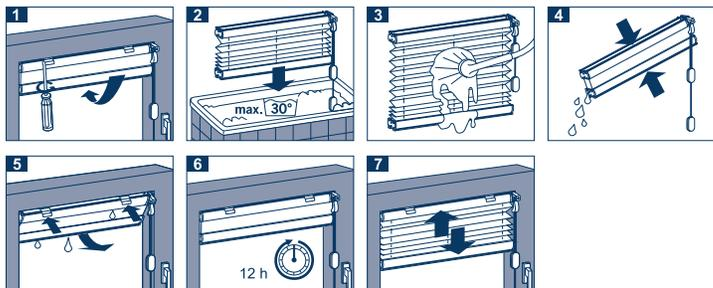
**1** Die Anlage aus der Halterung entfernen. **2** In ca. 30°C warmer Feinwaschmittellauge die Anlage schwenken. **3** Den Plisseestoff gut ausspülen. **4** Das Stoffpaket zusammenschieben und gut ausdrücken. Die Anlage darf nicht mehr tropfen. **5** Die Plisseeanlage feucht aufhängen. **6** Im geschlossenen Zustand trocknen lassen. **7** Während des Trocknens den Faltstore mehrmals öffnen und wieder schließen, damit die Falten nicht verkleben.
